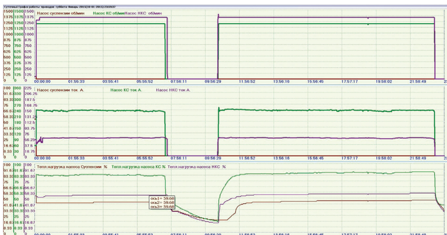
Рис. 4. Графики работы насосов кондиционной и некондиционной суспензии.
