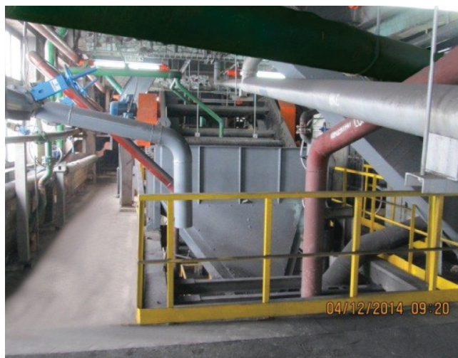
Рис. 5. Технологический комплекс: а и б – узлы установки и подготовки питания тяжелосреднего гидроциклона.
